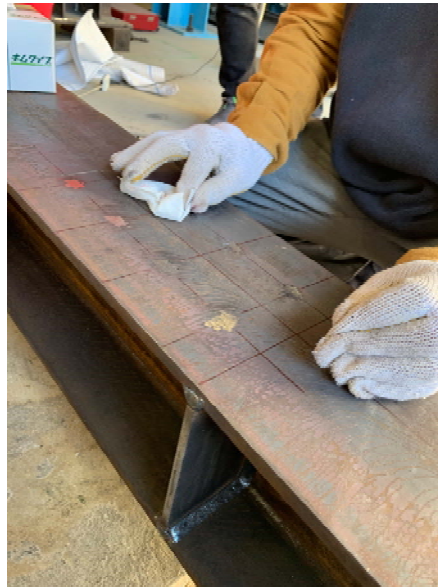
ひずみゲージを貼る
