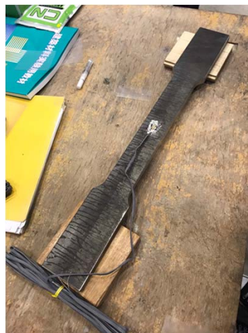
ひずみゲージを貼る
