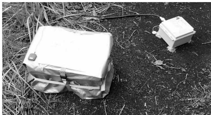
写真 1 臨時強震観測点の一例：右側のセンサーはアスファルト舗装に多用途接着剤を用いて固定されており、左側の箱内にロガーと鉛蓄電池と乾電池を併用した電源が入っており、防水シートで保護した上で、ロガーの時刻校正に用いる GPS アンテナが外部に貼り付けられている。
